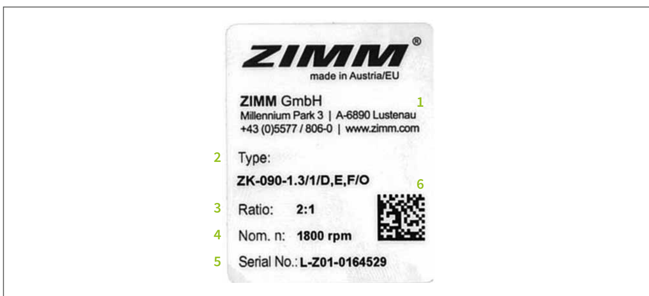
Рис. 3: Пример таблички с техническими данными для редукторов типоразмера ZK-090 и больше
