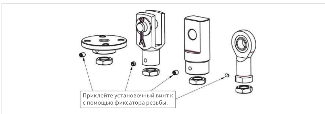
Рис. 7: После регулировки положения зафиксируйте опорный фланец, вилочную головку, шарнирный наконечник или головку с шаровым подшипником.
