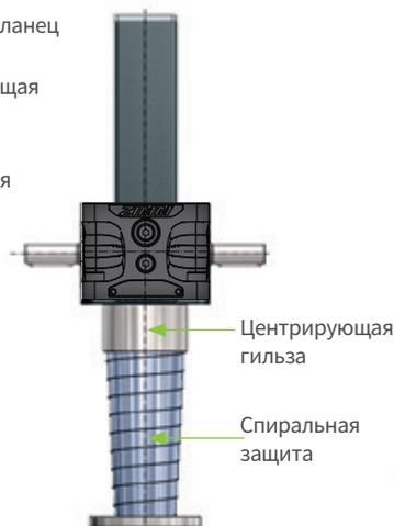
Установка спиральной защиты для исполнения RN/RL
