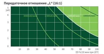
Эти карты используются для ориентации в стандартных промышленных условиях (температура окружающей среды 20°С и т. д.) и для правильного обслуживания (смазка и т. п.). Карты созданы на основе стандартной трапециевидной резьбы ZIMM Tr 18х4. В случае шарико-винтовой передачи КGT рабочий цикл может быть во много раз больше.
