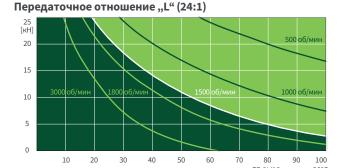
Эти карты используются для ориентации в стандартных промышленных условиях (температура окружающей среды 20°С и т. д.) и для правильного обслуживания (смазка и т. п.). Карты созданы на основе стандартной трапециевидной резьбы ZIMM Tr 30х6. В случае шариковинтовой передачи КGT рабочий цикл может быть во много раз больше.
