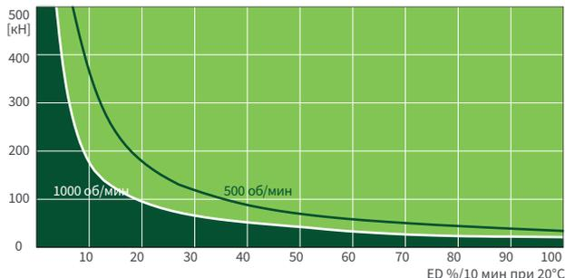
Эти карты используются для ориентации в стандартных промышленных условиях (температура окружающей среды 20°C и т. д.) и для правильного обслуживания (смазка и т. п.). Карты созданы на основе стандартной трапециевидной резьбы ZIMM Tr 120x16. В случае шариковинтовой передачи KGT рабочий цикл может быть во много раз больше.
