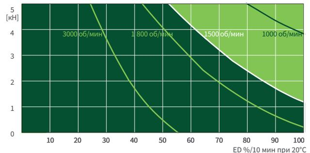
Эти карты используются для ориентации в стандартных промышленных условиях (температура окружающей среды 20°C и т. д.) и при правильном обслуживании (смазка и т. п.). Карты созданы на основе стандартной трапецидальной резьбы ZIMM Tr 18x4. В случае шарико-винтовой передачи KGT продолжительность включения может быть во много раз больше.
